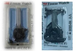
冷範凍監視片破裂、變色之範例
